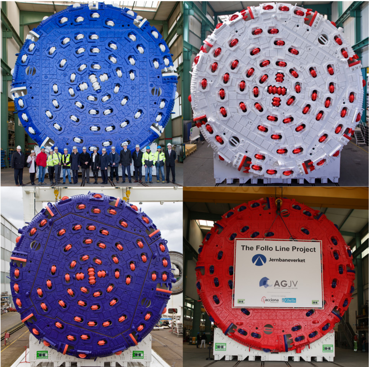
De fire tunnelboremaskinene i Follobanen har en diameter på hele 9,96 meter, og er dekorert i farger fra det norske flagget.
