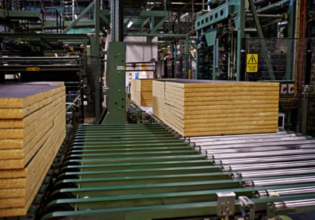
Etter smeltingen kommer resultatet ut i form av noe som ligner mest på sukkerspinn. Deretter presses dette sammen til den gule isoleringen vi kjenner så godt. Foto: Geir Dokken
