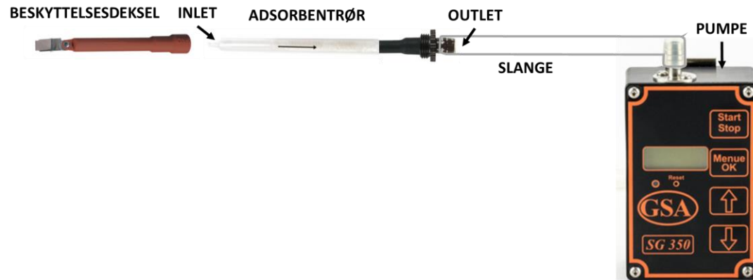
Figur 1: Oppsett av adsorbentør for måling av aminer. Pumpen kobles til glassrøret ved hjelp av en slange. Slangen går mellom pumpen og outlet -åpningen på adsorbentørret. Et beskyttelsesdeksel plasseres over glassrøret.
