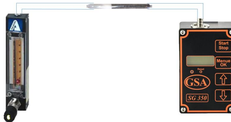
Figur 3: Oppsett for måling av flow ved hjelp av flowmeter. Flowmeter kobles til inlet-åpningen av adsorbenttrøret med en slange. Pumpen er tilkoblet outlet-åpningen av adsorbenttrøret.
