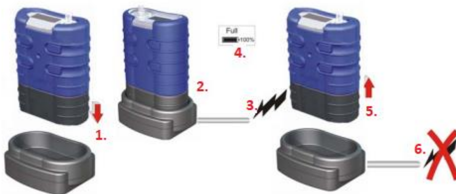
Figur 1: Oppsett og rekkefølge for lading av Casella TUFF4 Pro IS pumper. Sett pumpa i ladestativet med batteriet nederst (1,2), før ladestativet kobles til strøm (3). Under oppladning vil det blinke rødt, helt til batteriet er fulladet (4). Da skifter lyset til konstant blått. Når pumpa er ladet ferdig fjernet pumpa fra ladestativet (5) før strømmen kobles fra (6).
