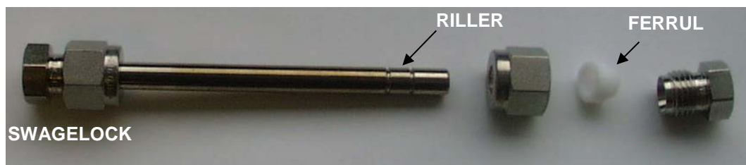
Figur 1. ATD-rør med Swagelock mutter-system. Merk at ferrulen skal ha koningen ut fra røret.
