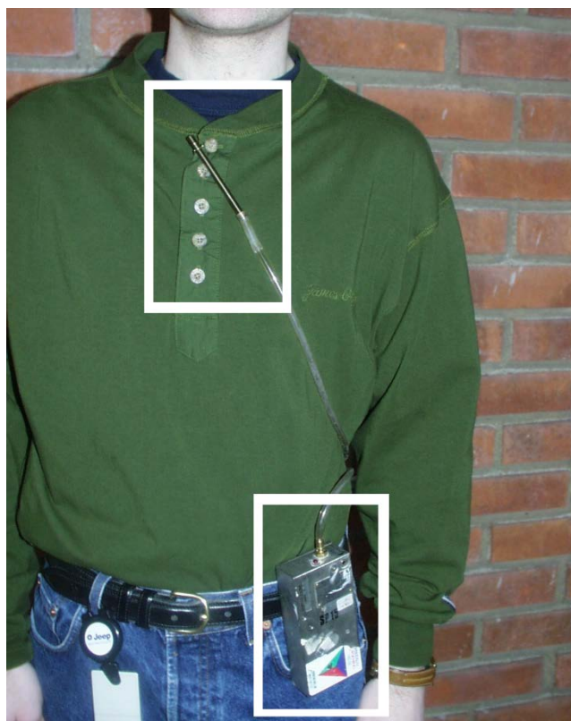
Figur 2. PERSONLIG PRØVETAKING MED PUMPE
