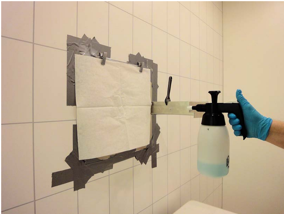
Bilde 2: Metallplate med arm for sentrering og eksakt avstand. (Foto: STAMI)
